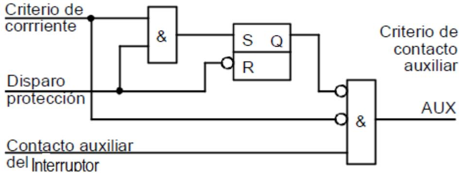
De esta manera, se da preferencia al criterio del flujo de corriente por su mayor seguridad y se evita un mal funcionamiento a consecuencia de un defecto en los contactos auxiliares del interruptor.
