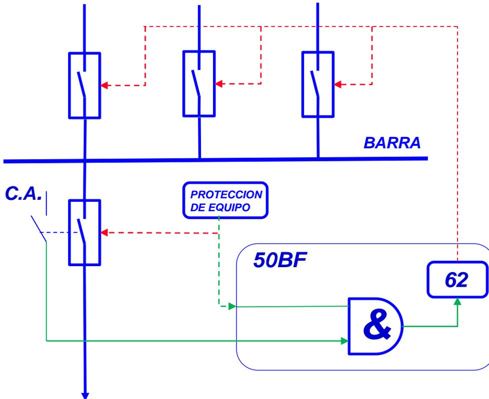
*Para los relés de protección cuyos criterios de disparo no están adaptados a la circulación de una corriente de medida (p.ej. protección Buchholz), el flujo de la corriente no proporciona en el esquema anterior ninguna orientación fiable para reconocer el funcionamiento correcto del interruptor de potencia.*
