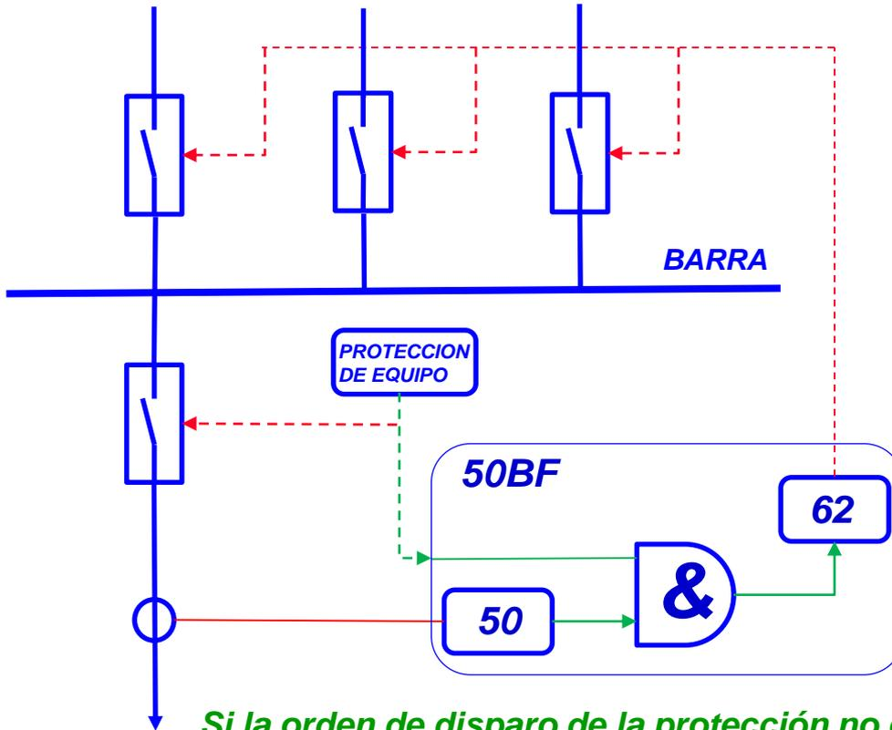
*Si se genera por parte de la protección de la línea una orden de disparo al interruptor de potencia, esta señal será conducida al mismo tiempo a la protección de falla de interruptor de potencia.*
